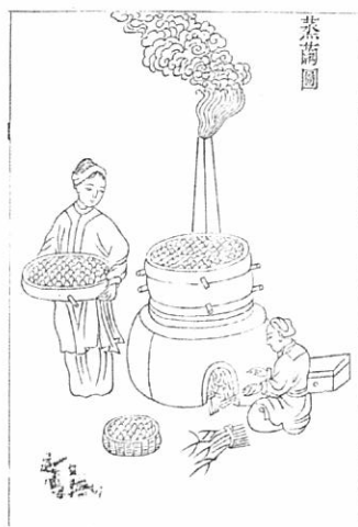
図 35 清代蒸気殺蛹の図
