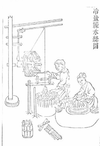
図 38 煮繰分業・沈み繰り（繰水法）
