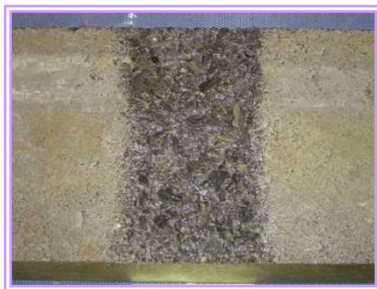
コンクリート試験体の摩耗状況
