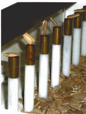
写真1 ノズルに吸着された種子
