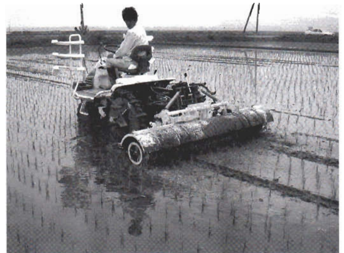
図3 補助車輪を使用している除草作業
