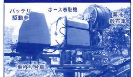
図4. 乗移り台車に搭載したバッテリー
