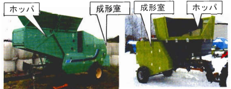
写真1 細断型ロールペーラ (左: バーチェーン式、右: ローラ式)
