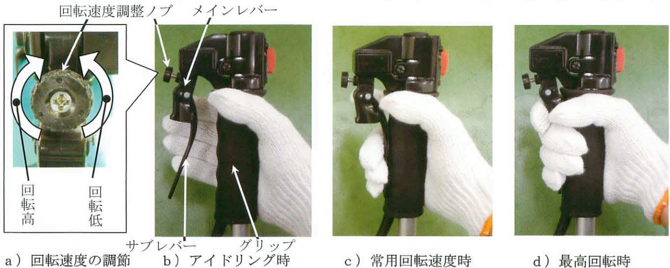
図2 スロットルレバーの操作方法
