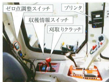
図2 キャビン内の構成
