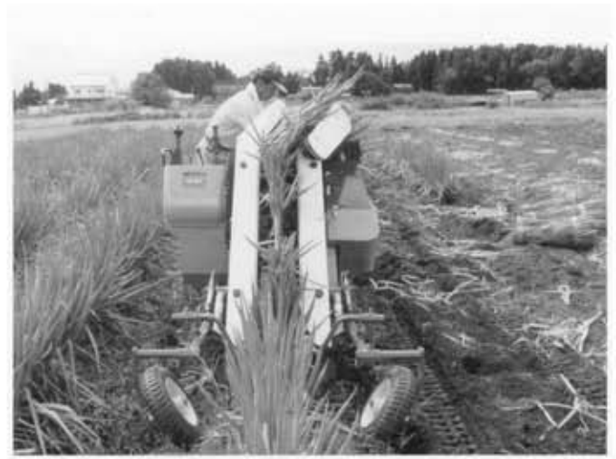
写真1 収穫作業（ガイド輪で畝に追従走行）
