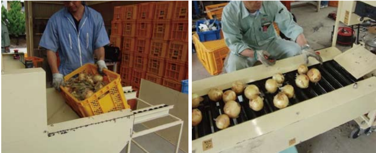
図2 2名1組での作業（左：供給部へのたまねぎの補給、右：選別部での作業）
