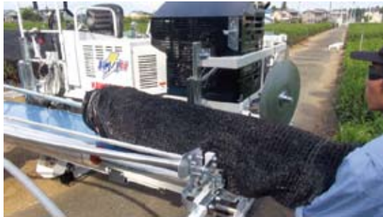
図6 巻き取った資材の取り外し
