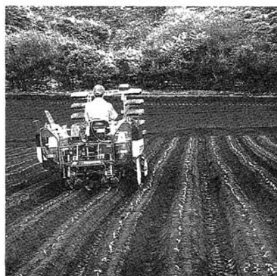
開発機による傾斜地(約10度)の移植作業
