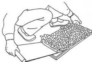
図9 パルプモードセルポット苗の移植機へのセット法
