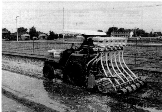
写真1 試作機による湛水耕耘施肥播種作業
