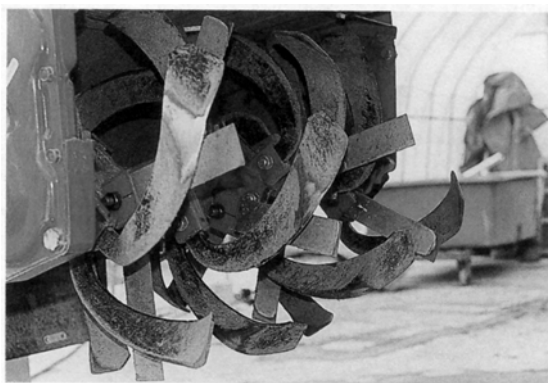
第 1 図 板バネ (写真黄色部分) を 14 枚装着した土槽試験ロータリ耕うん部
