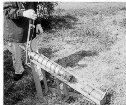
写真2 土塊押し出し装置
