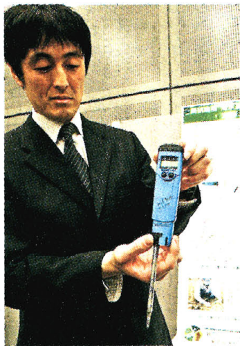
採取した土に突き刺してEC値を測る機器（6日、盛岡市で）
