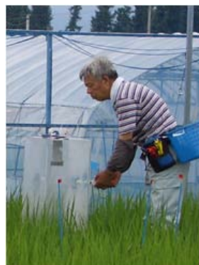
図1. メタン測定 (チャンバー法)
