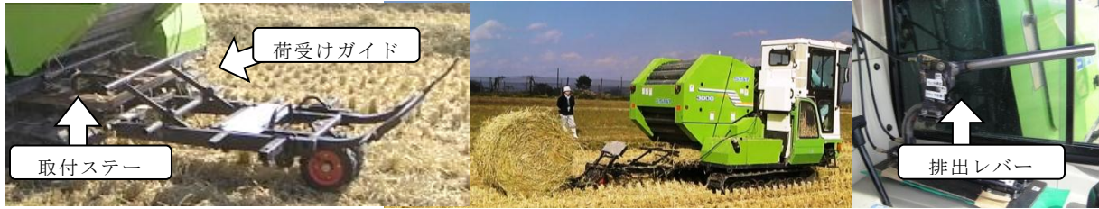
図 1 自走式ロールベアラとロールキャリア
