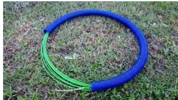
写真8 プラチェーン挿入に用いた通線ワイヤー
