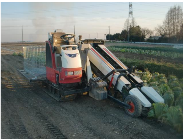
図1 加工・業務用ハクサイ刈取アタッチメントを装着した高能率キャベツ収穫機
