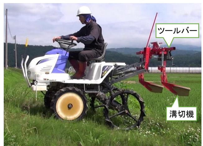
図2 後輪昇降機構を利用した傾斜地走行の様子
