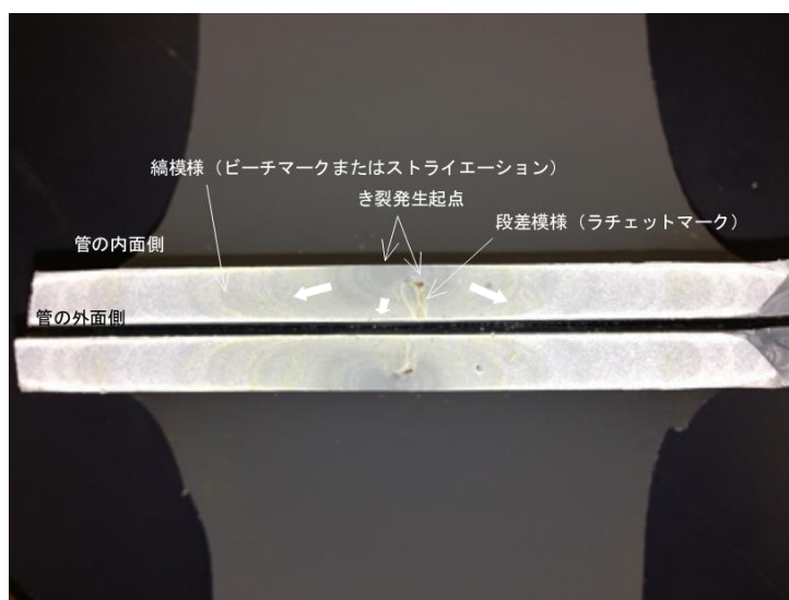
図6 き裂の破面
