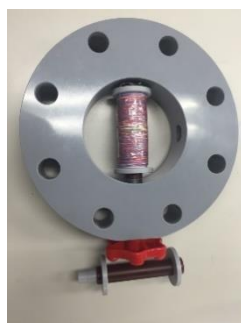
図 14 管内検査用カメラ搭載ロボットの追跡用テグスを巻き取るリール
