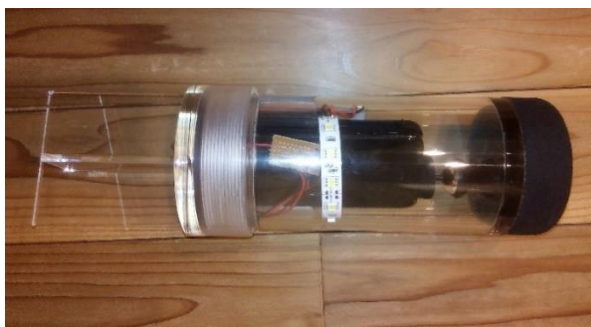
図12 満水状態の管内部を観察する管内検査用カメラ搭載ロボットの例
