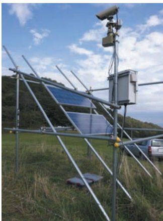
太陽光パネル電源で牧草地に設置した熱画像カメラ搭載型のモニタリングシステムと受像画面（ニホンジカ）
