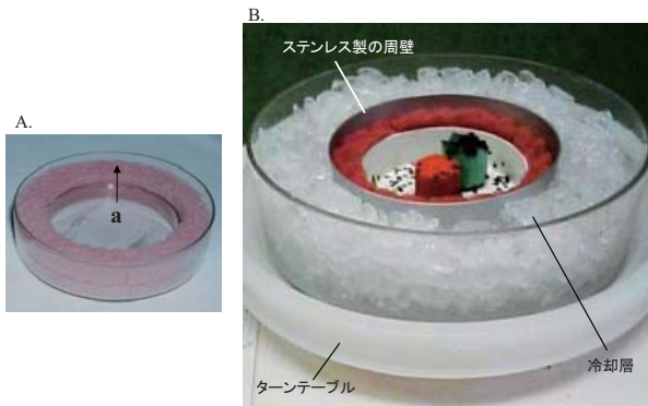
図1. 冷却式隔離容器によるマダニ隔離技術の改善
