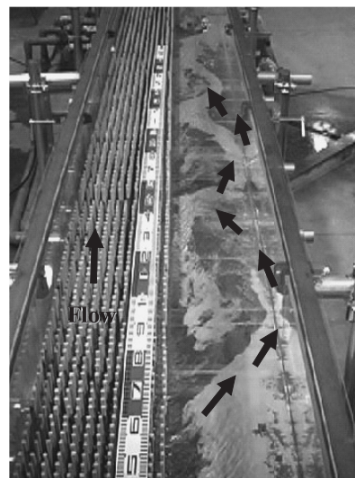
Photo 2-7 模擬植生周辺の大規模水平渦のアルミ粉による可視化結果 (Case 0)
