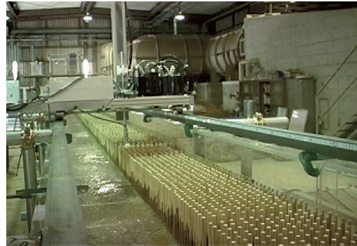
Photo 2-5 流れの可視化に用いた実験水路（農村工学研究所内） Experimental flume used for flow visualization (in National Institute of Rural Engineering)
