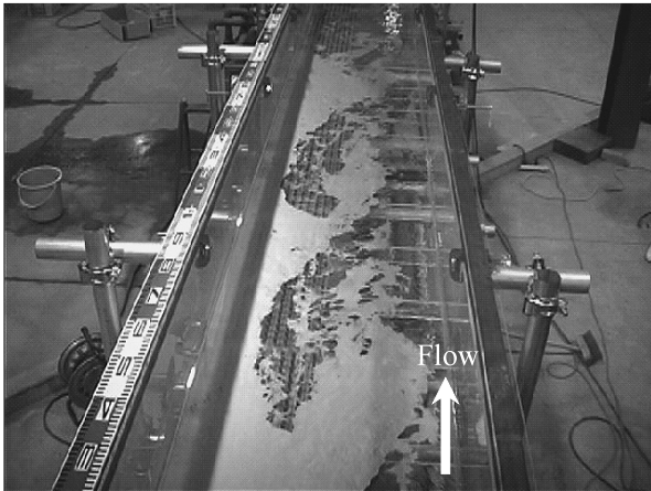
Photo 3-3 模擬植生周辺の大規模水平渦のアルミ粉による可視化結果 (case 2)
