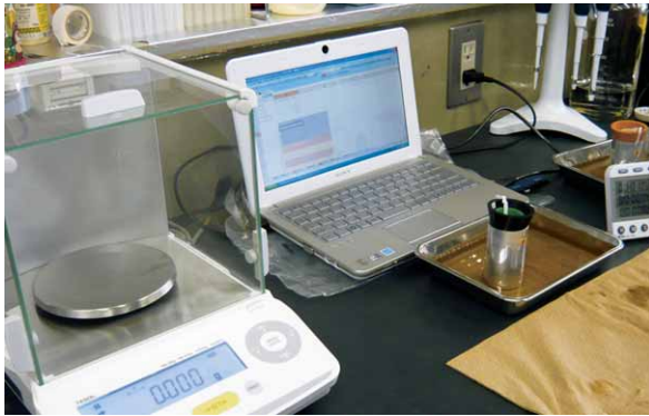
図1 米粉吸水性評価用装置
